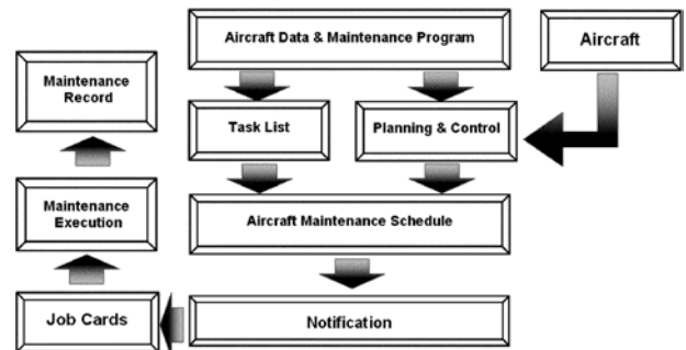
แผนภาพที่ 1 การใช้ระบบ SAP ในการควบคุมและจัดการด้านข้อมูลและเอกสารการตรวจสอบบำรุง ที่มา : ข้อมูลการแนะนำและอบรมระบบ SAP ของฝ่ายช่าง ( http://dtweb , 2010)
